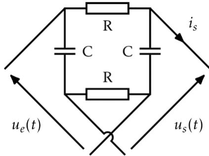
1) Déterminer, en régime sinusoïdal forcé, la tension de sortie  $u_s(t)$  si la tension d'entrée  $u_e(t) = U_e \cos(\omega t)$  et lorsque la sortie est ouverte ( $i_s(t) = 0$ ).
